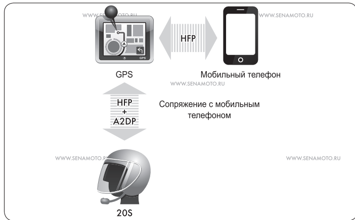
Сопряжение с системой GPS как с мобильным телефоном.
